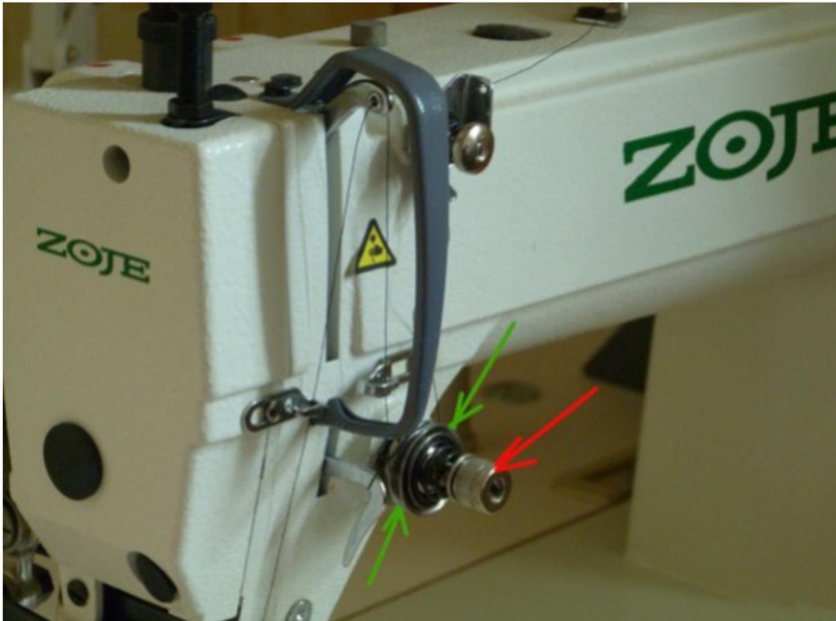
Indem wir die Schraube anziehen, werden die Scheiben fester auf den Faden gedrückt, und indem wir sie lockern, werden sie schwächer.
