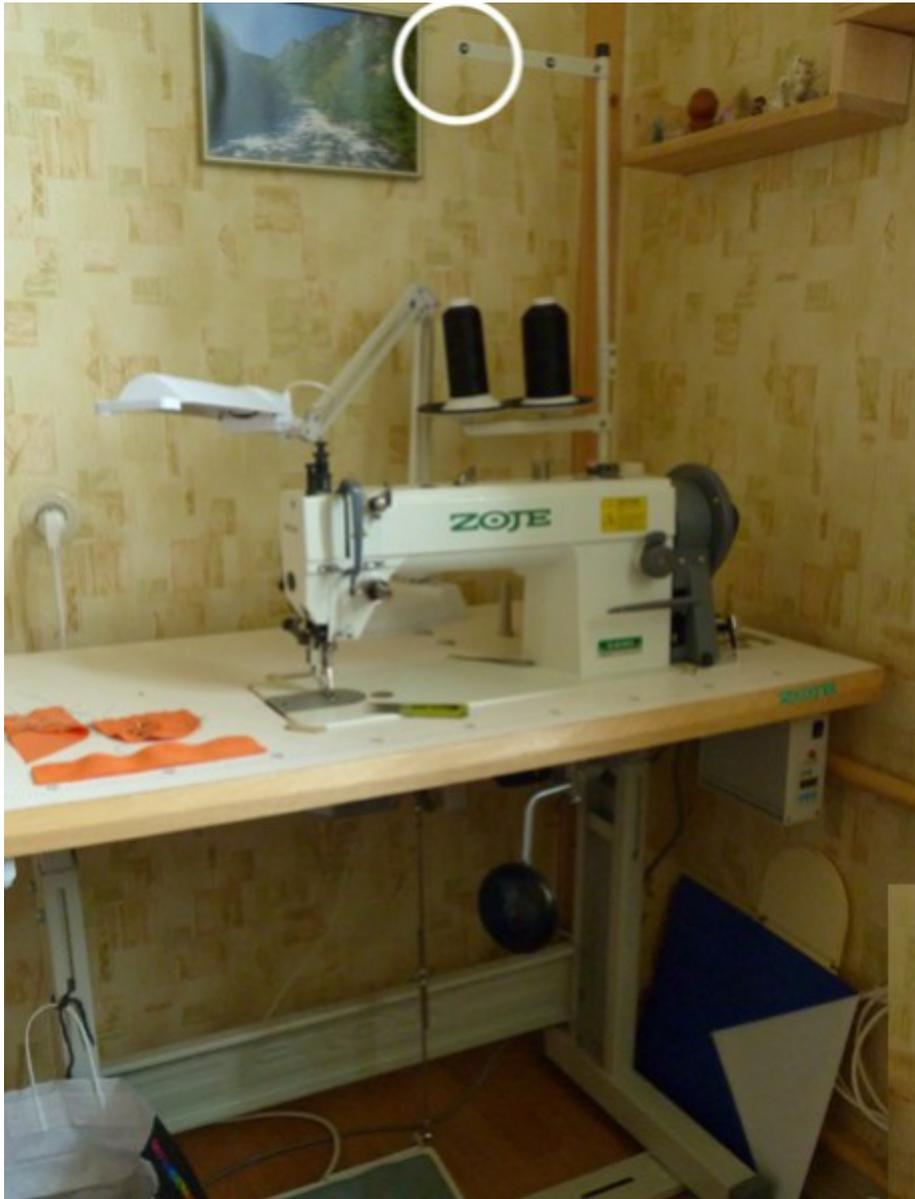
Von diesen sehen Sie zwei Löcher. Sie können natürlich in das zweite Loch zum Beispiel einen anderen Faden für das Nähen vorbereiten, zum Beispiel in einer anderen Farbe. Danach können Sie je nach Bedarf wechseln.
