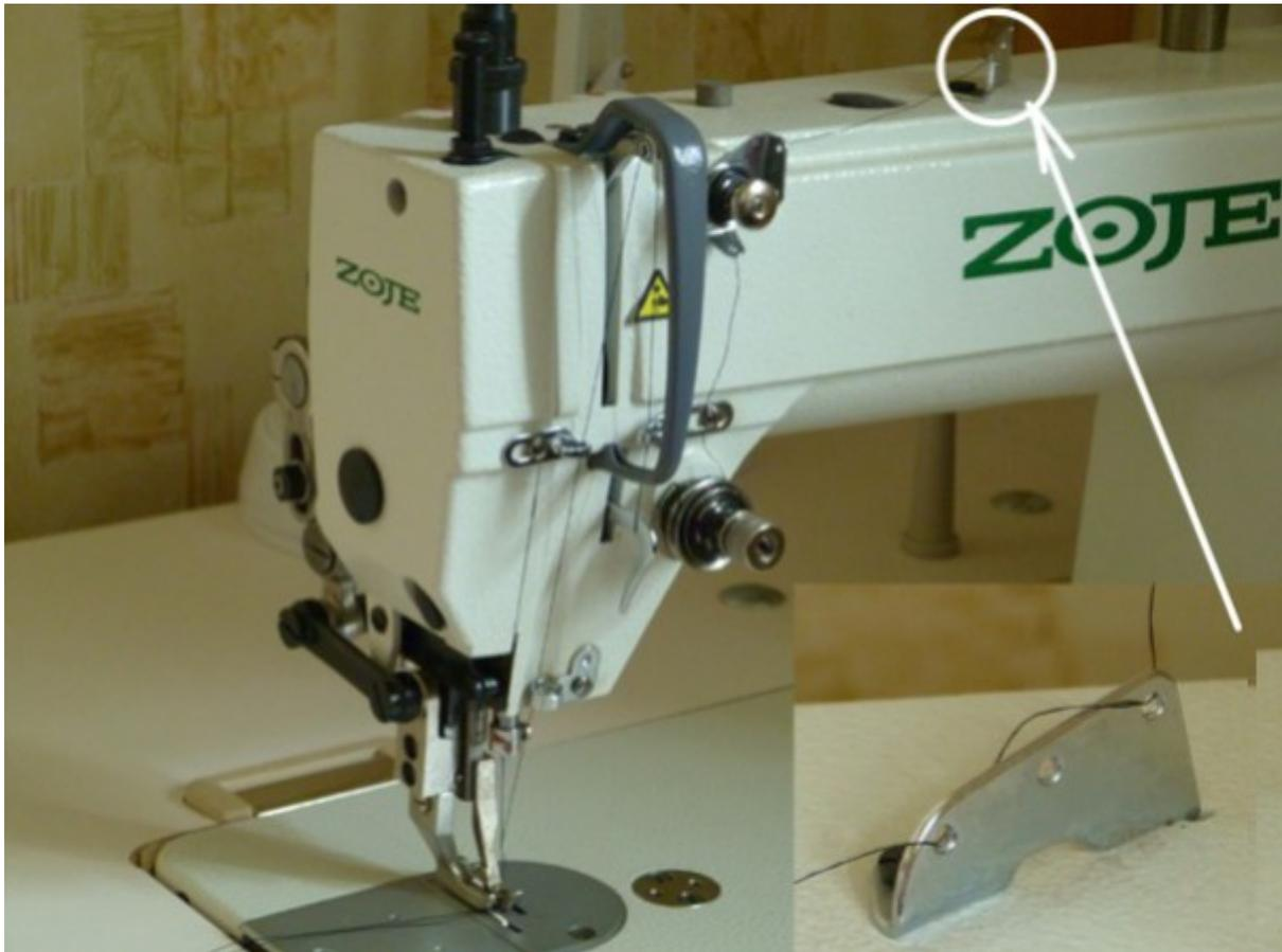
Eine professionelle Technik besteht darin, den Faden auf verschiedene Arten durch die Führungsscheibe zu fädeln. Dies ist nur eine Möglichkeit, um zusätzliche Spannung auf den Faden auszuüben oder ein Verdrehen des Fadens zu verhindern. Probieren Sie verschiedene Varianten aus, um den Faden durch die Löcher zu führen und experimentieren Sie mit den Effekten.
