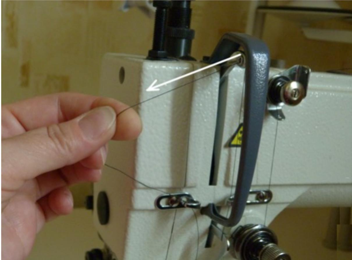
Der Grund dafür ist, dass wenn Sie den Kniehebel vollständig anheben, heben Sie den Nähfuß komplett an - dadurch befreien Sie den Faden vollständig aus den "Greifern" der Oberfadenspannung.
